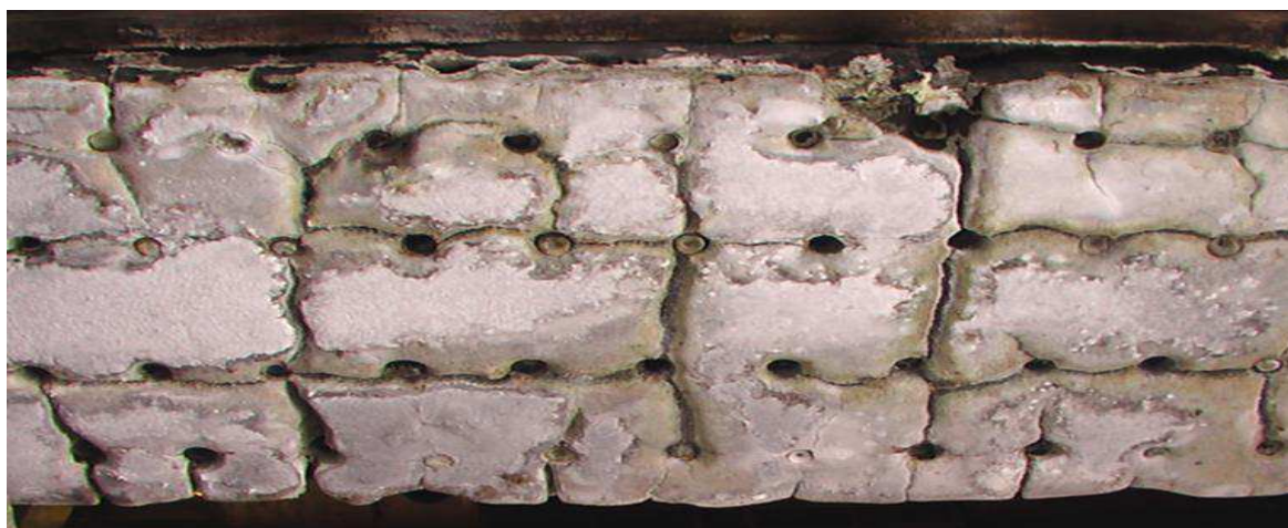
Рисунок 4 - Подошва анода (с отклонениями от технологических параметров)
