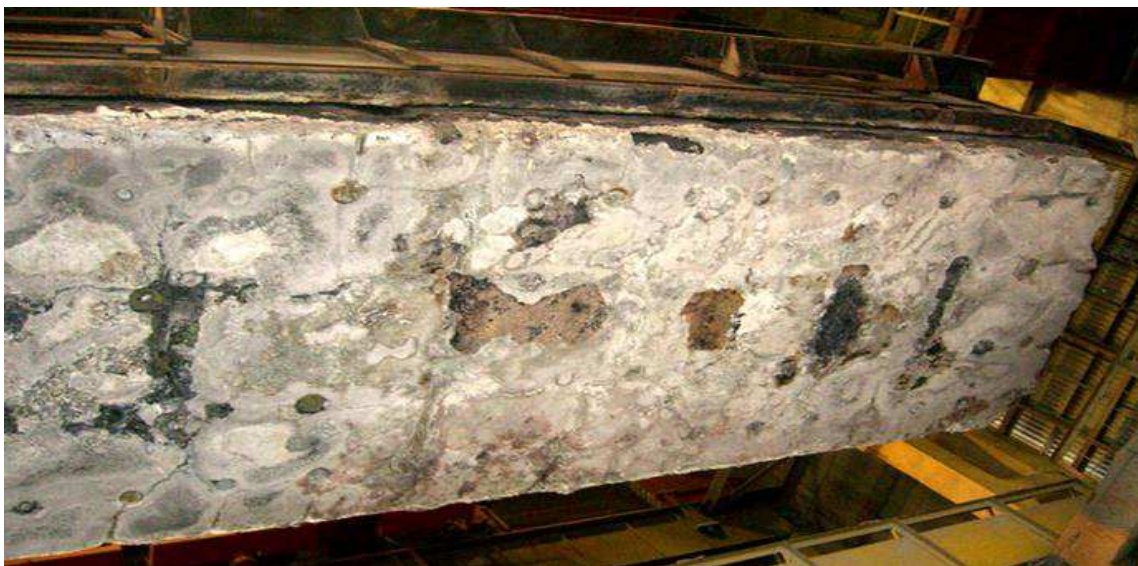
Рисунок 3 - Подошва анода (без отклонений от технологических параметров)
