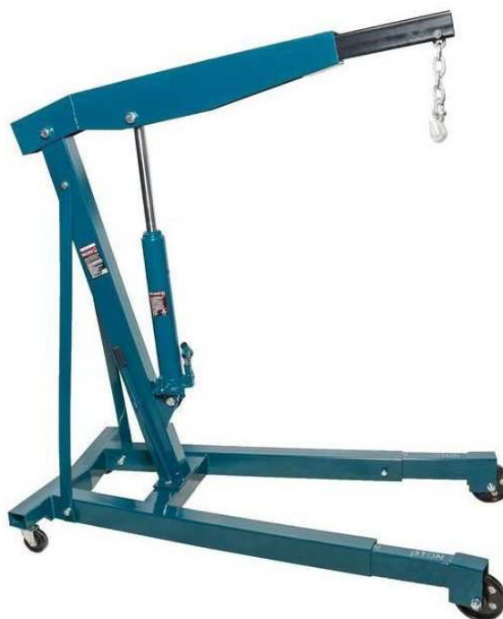
Рисунок 8 – Внешний вид гуськового крана Forsage F-TR33002B
