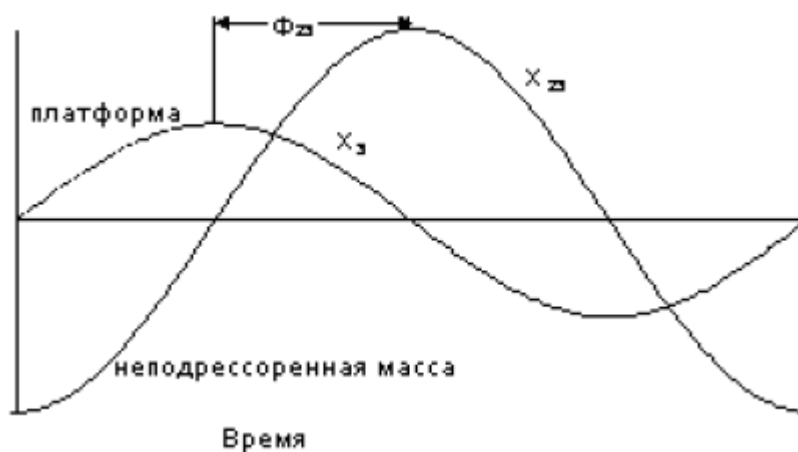
Рисунок 13 – Фазовый угол: X_3 – смещением платформы стенда; \Phi_{23} – фазовый угол; X_{23} – смещение между неподдрессоренной массой и платформой стенда.
