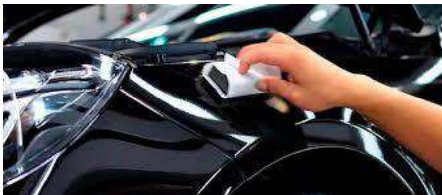
Рисунок 4.5 – Защита кузова керамическим составом
