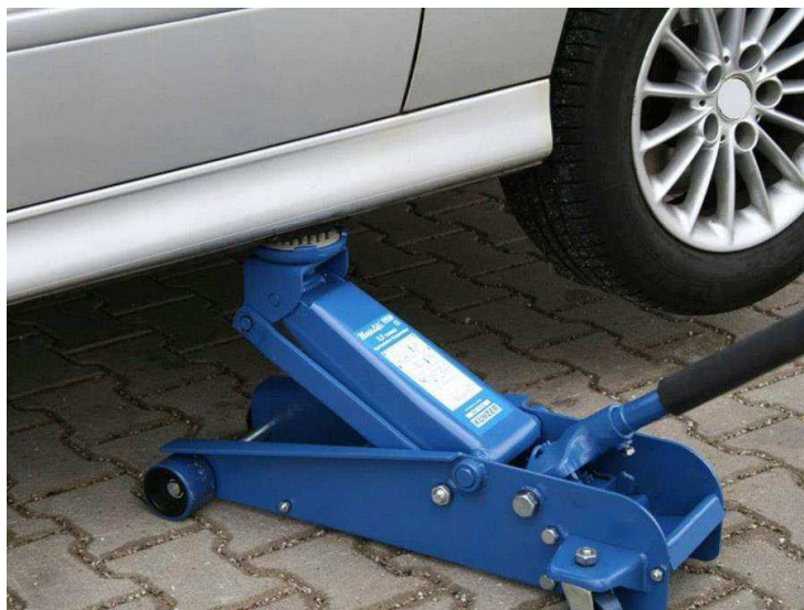
Рисунок 4.3 – Вывешивание автомобиля домкратом
