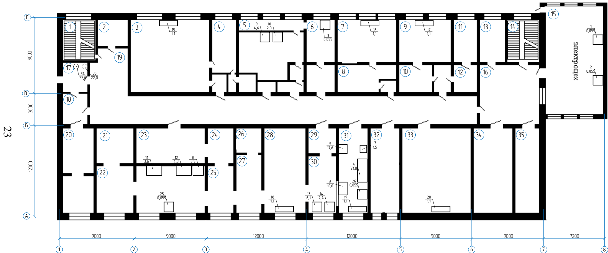
Рисунок 2.1 – План расстановки электрооборудования на 1-м этаже
