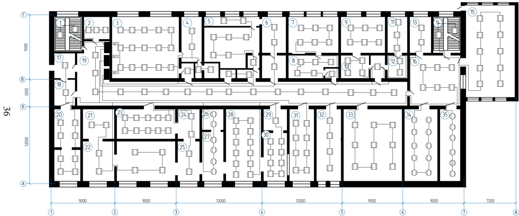
Рисунок 3.5 – План осветительной сети, 1 этаж
