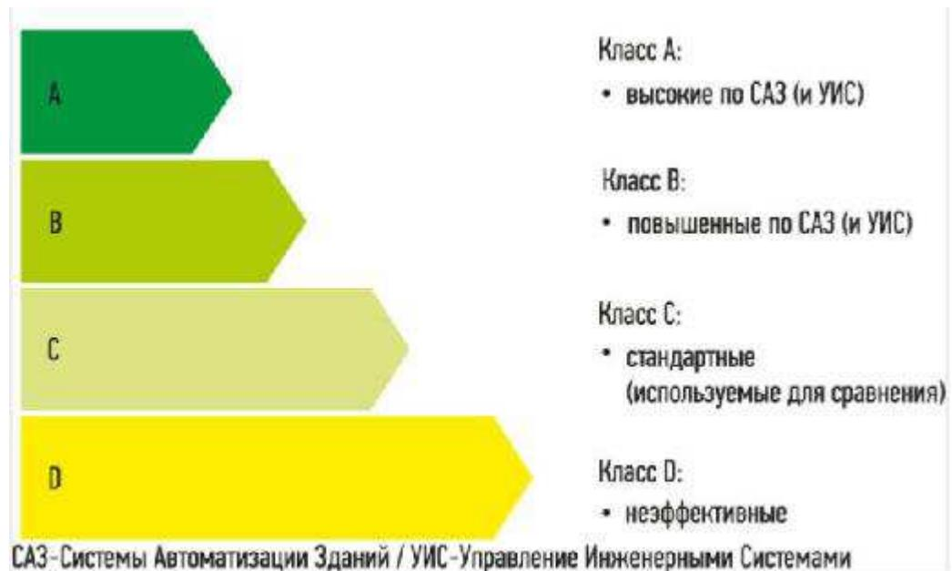
Рисунок 14 – Классы энергетических характеристик систем автоматизации
