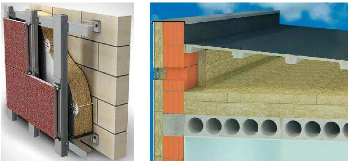
Рисунок 11 – Вентилируемые стена и перекрытие
