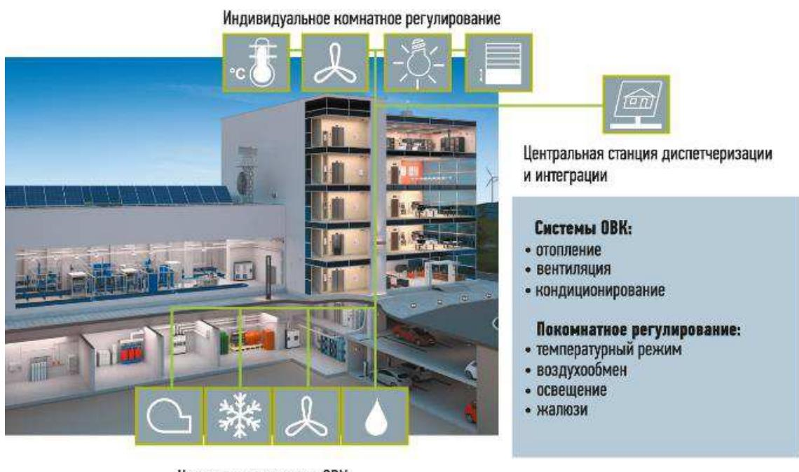
Рисунок 12 – Системы автоматизации здания
