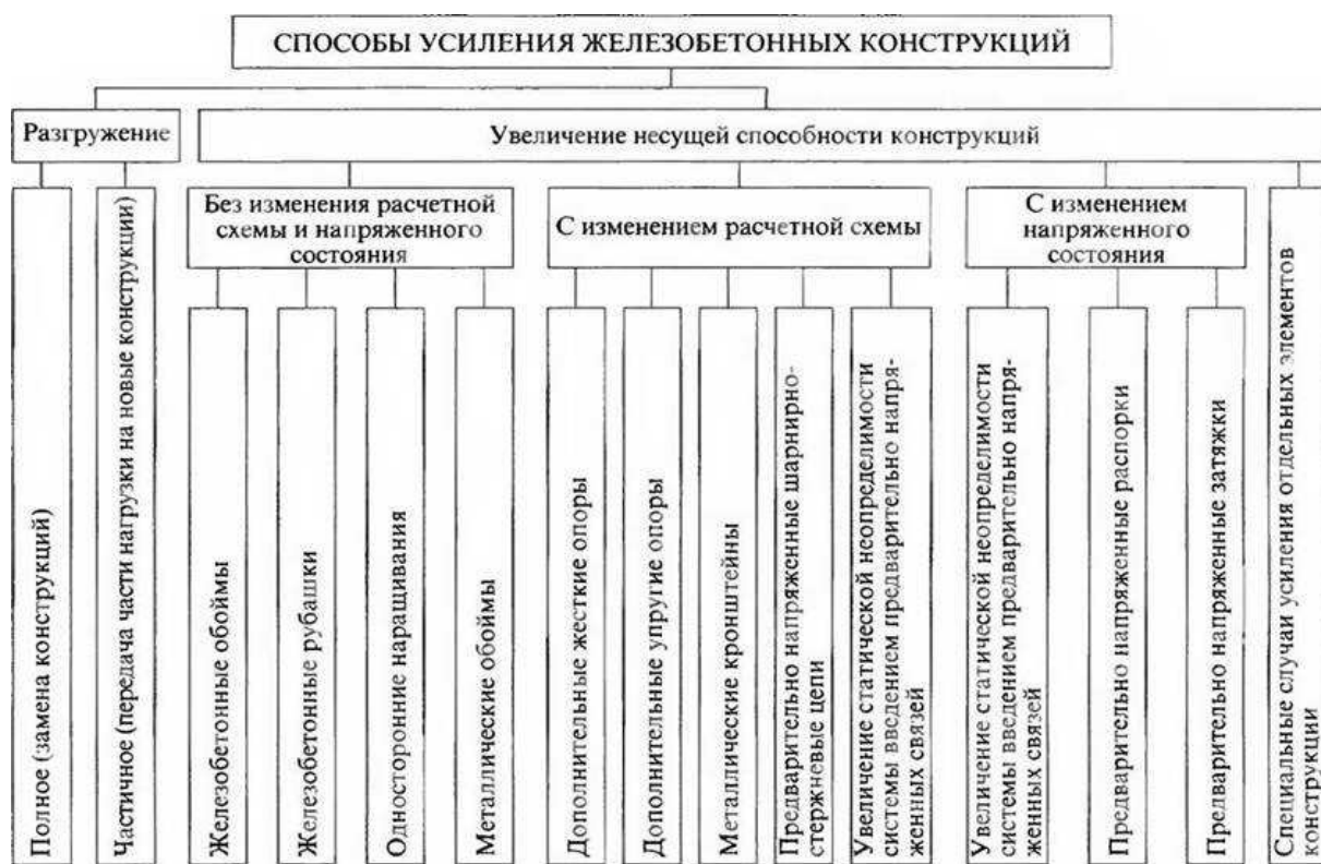
Рисунок 1.1 – Существующие методы увеличения прочности железобетонных конструкций
