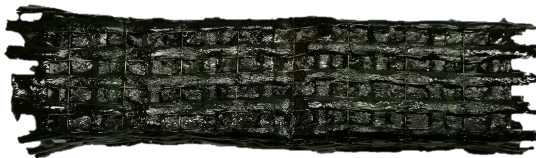
Рисунок 3.5 – Образец, усиленный в 1 слой углеродной сетки после испытания на прочность
