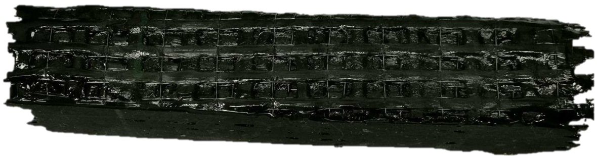
Рисунок 3.7 – Образец, усиленный углеродной сеткой в 2 слоя после испытания на прочность
