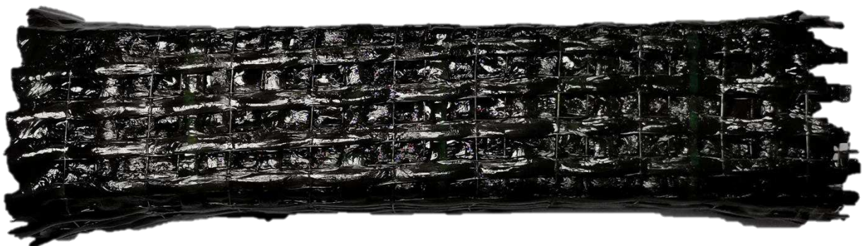
Рисунок 3.3 – Образец, усиленный в 2 слоя углеродной сетки.
