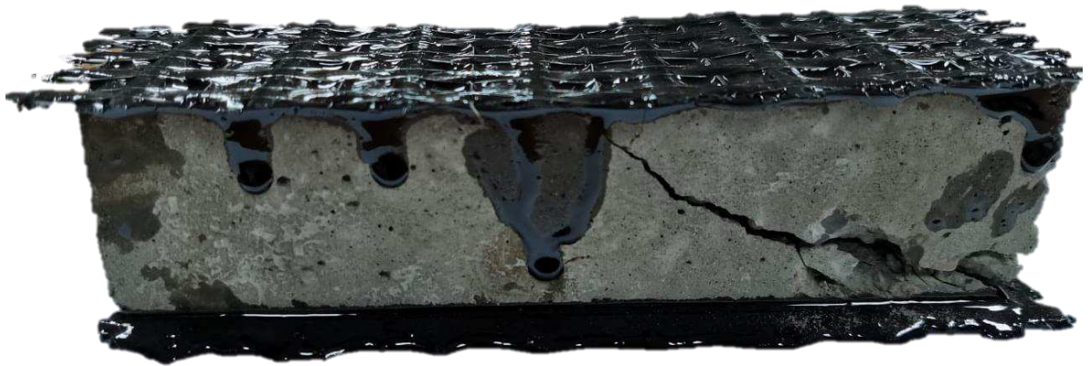
Рисунок 3.16 – Образец, усиленный армированием сверху и снизу в 2 слоя после испытания на прочность
