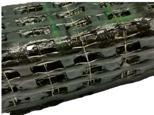
Рисунок 3.8 – Деформация углеродной сетки после разрушения образца
