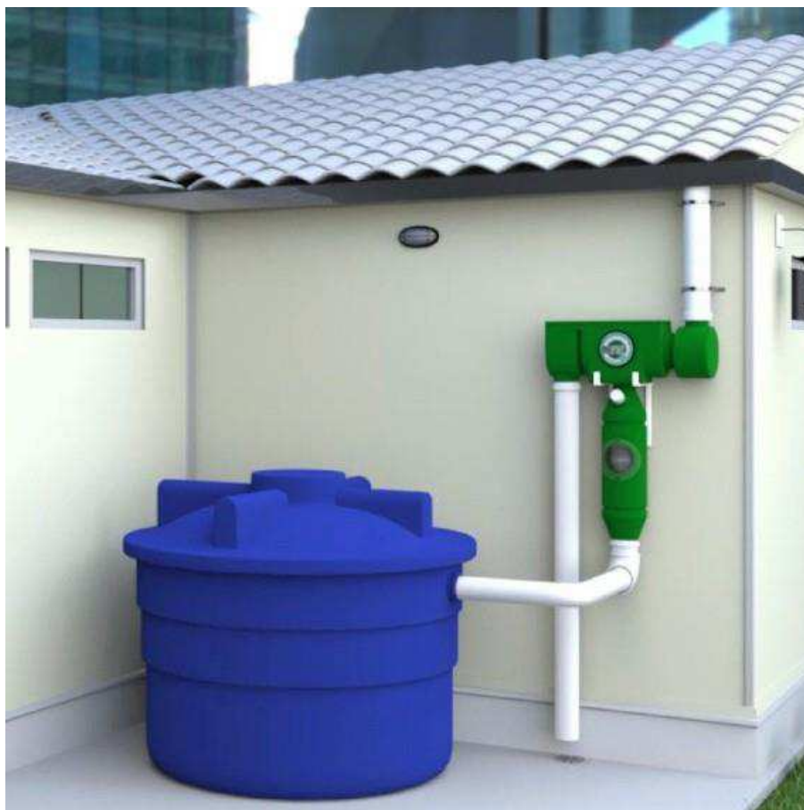
Рисунок 12 – Установка накопительной емкости на поверхности
