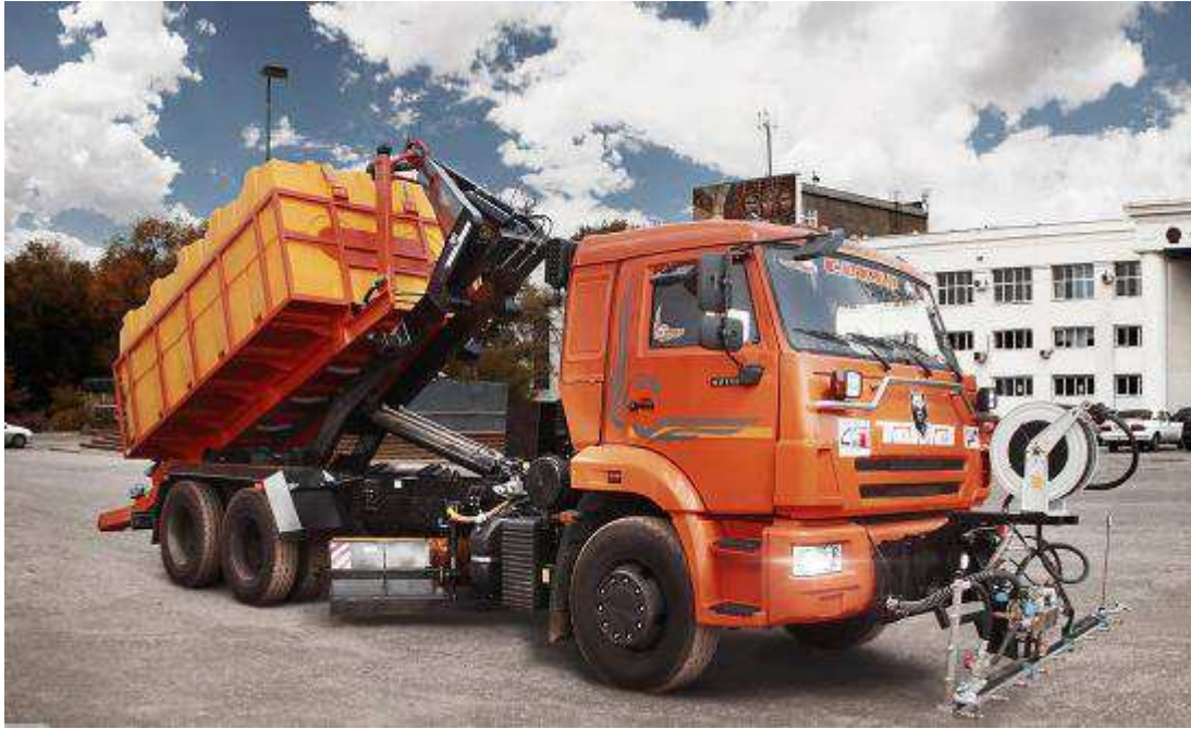
Рисунок ГЗ – Вид комбинированной дорожной машины МКДУ-3 на полноразмерном грузовом шасси в летний сезон с откидным кузовом
