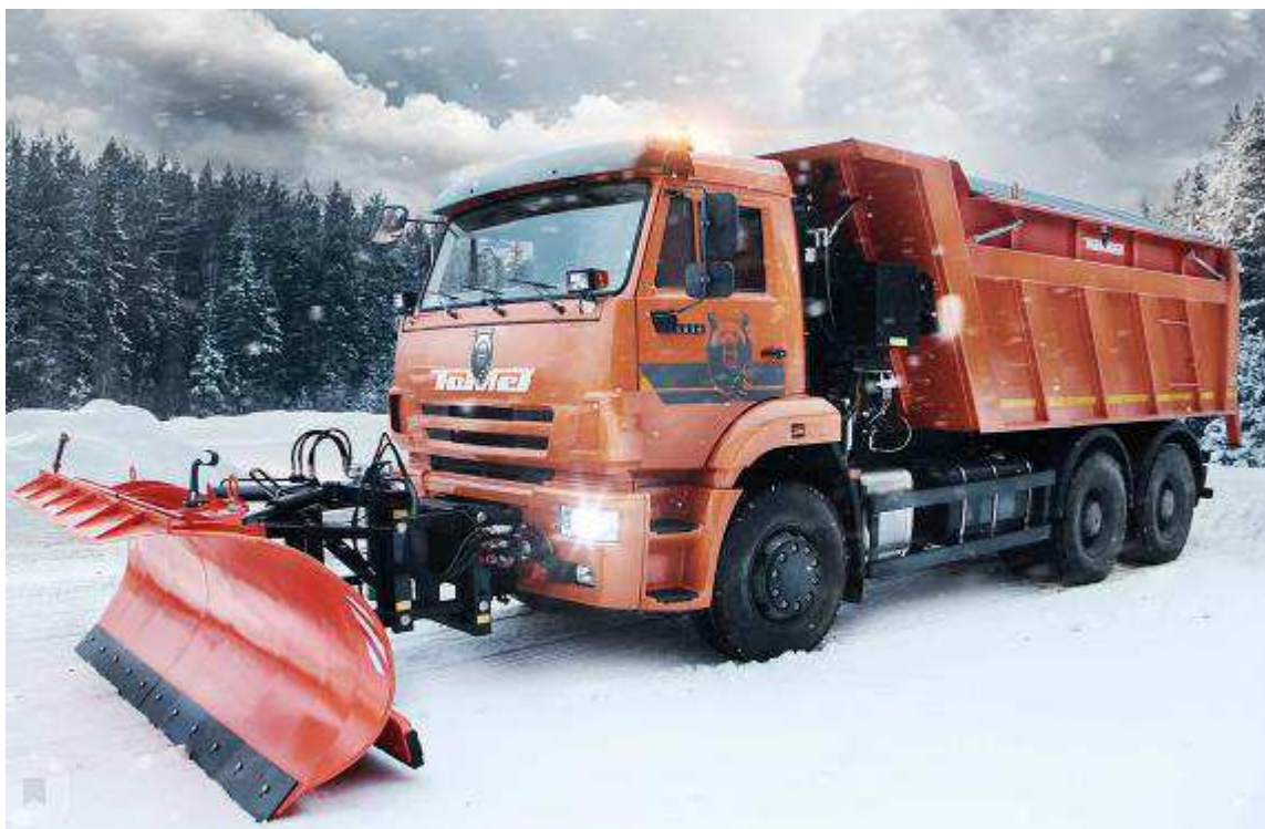
Рисунок Г1 – Вид комбинированной дорожной машины МКДУ-3 на полноразмерном грузовом шасси в зимний сезон
