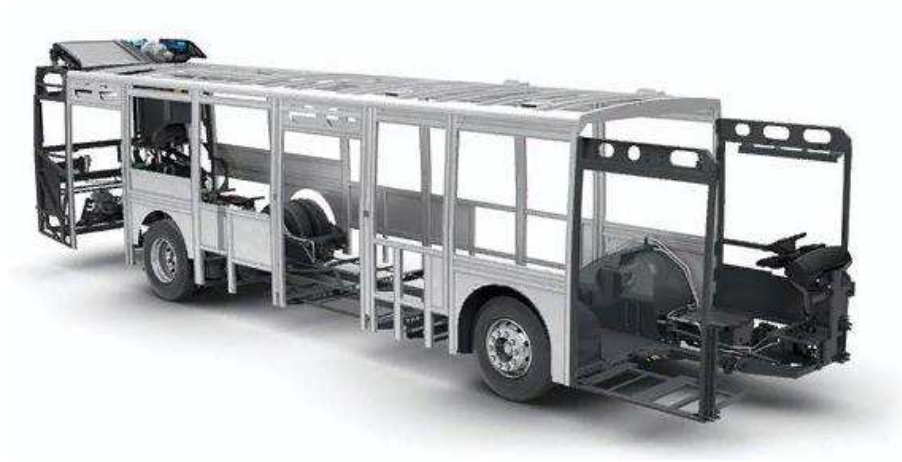
Рисунок 2.2 – Городской электробус, построенный на основании гибридной платформы
