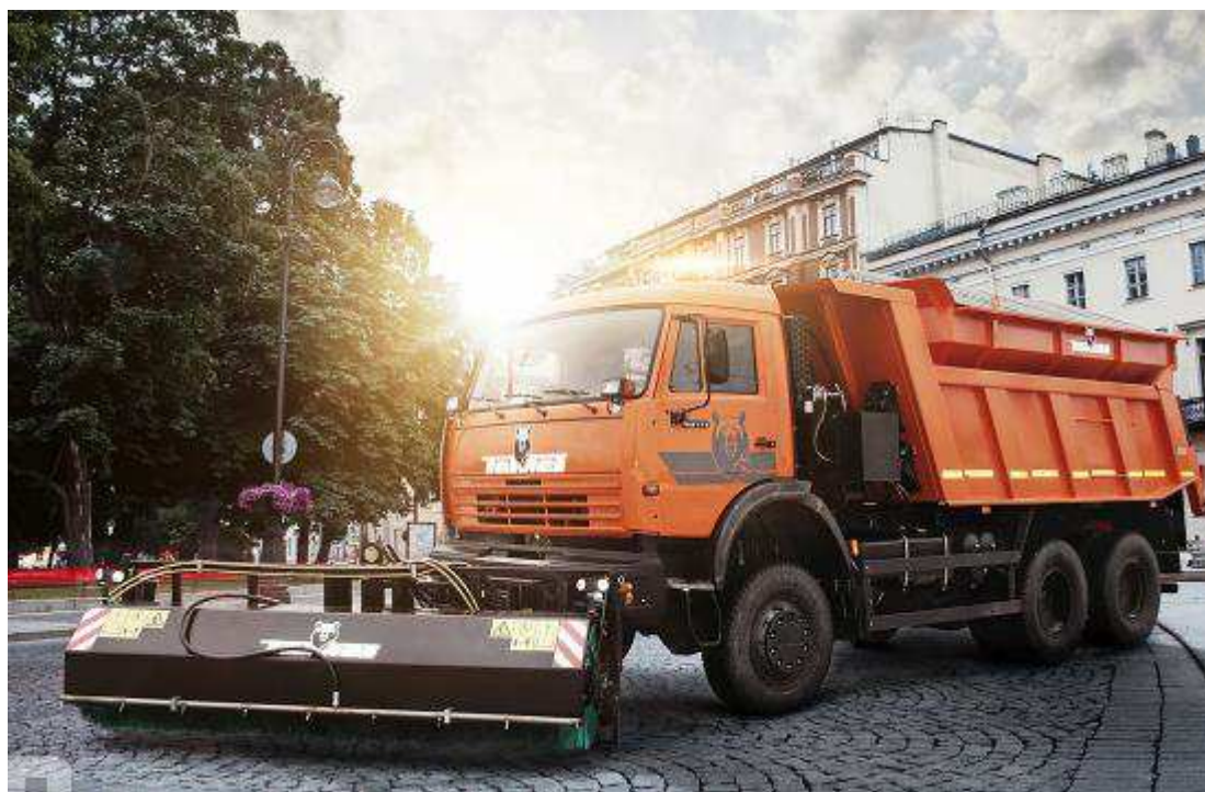
Рисунок Г2 – Вид комбинированной дорожной машины МКДУ-3 на полноразмерном грузовом шасси в летний сезон
