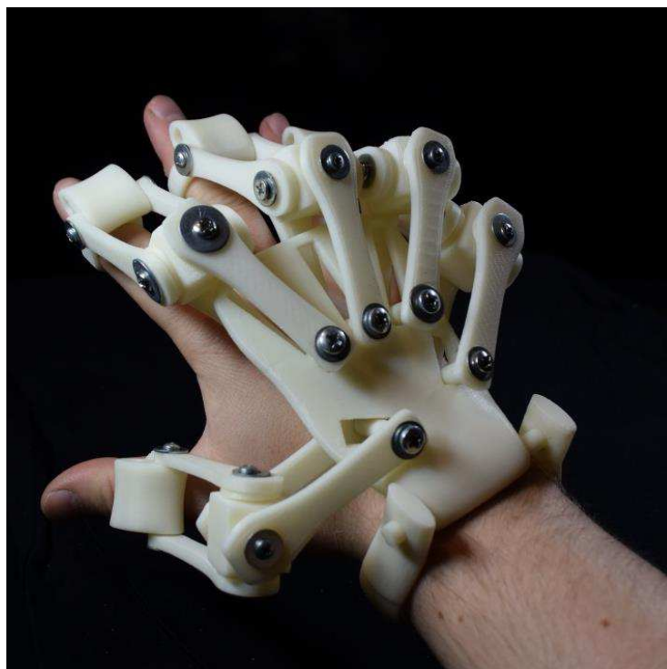
Рисунок 22 – Готовый макет перчатки, распечатанной на 3D-принтере
