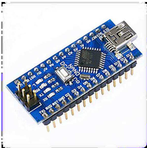
Рисунок 16 – Платформа Arduino Nano на основе микроконтроллера ATmega 328P
