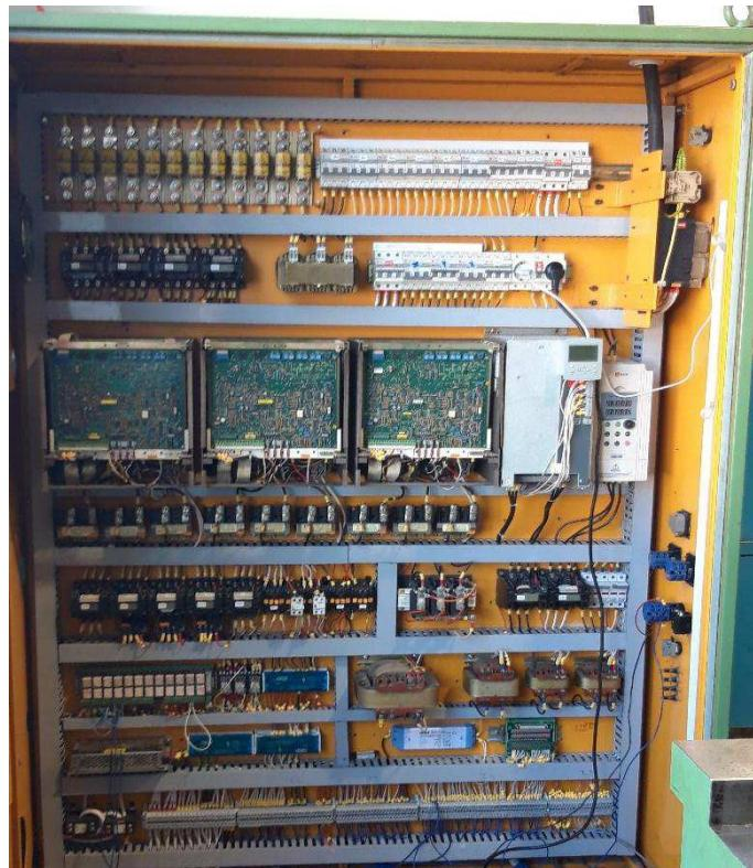
Рисунок 1.2 – Панель электроавтоматики станка
