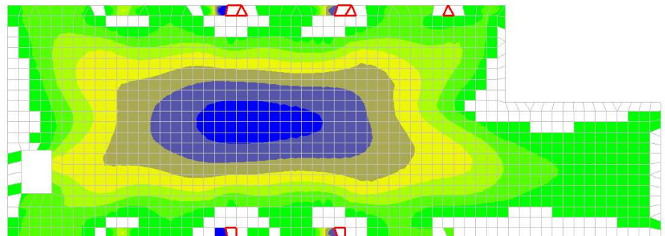
Рисунок 2.10 - Распределение нижней арматуры по оси Y с шагом 200 мм
