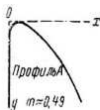
Рисунок 4.1 – Очертание водосливной стенки Кригера-Офицера, тип А
