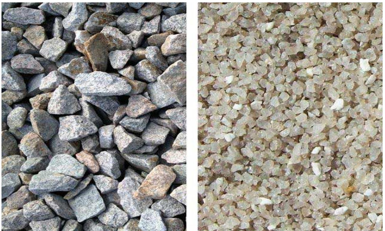
Рисунок 9.1 – Заполнители для бетона
