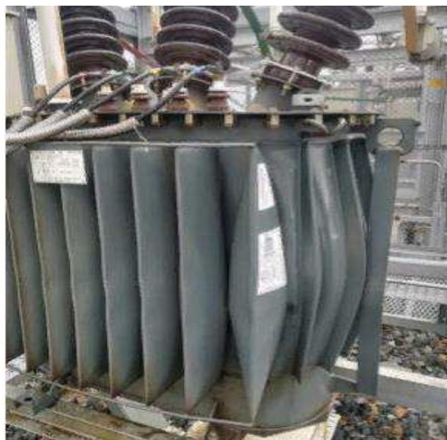
Рисунок 34 – Повреждение бака трансформатора после внутреннего КЗ
