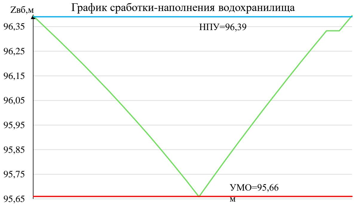
Рисунок 2.2 – График сработки и наполнения водохранилища в условиях маловодного и средневодного года
