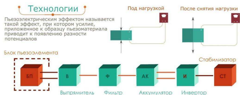
Рисунок 9.4 – Примерная схема работы элемента фасадной системы
