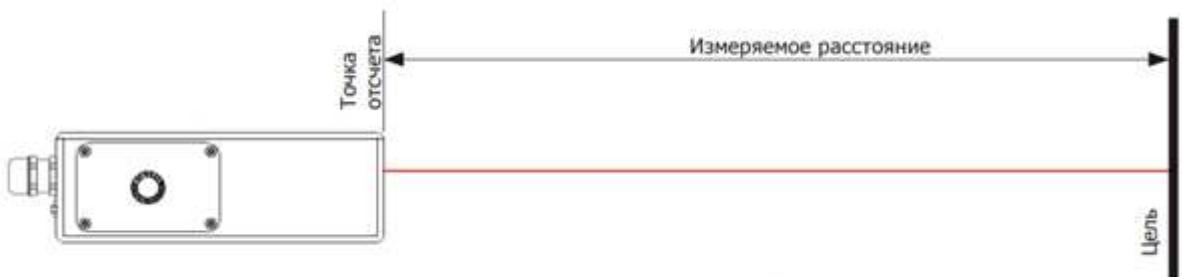
Рисунок 8.4 – Принцип работы дальномера
