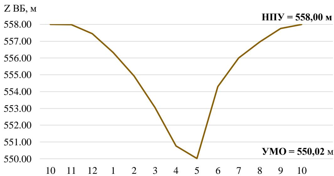
Рисунок 2.6 – График сработки- наполнения водохранилища
