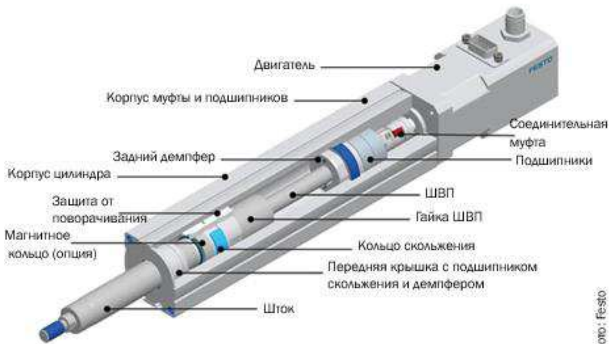
Рисунок 9.4 – Устройство электроцилиндра
