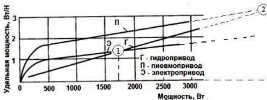
Рисунок 9.6 – Удельная мощность, отнесенная к весу, различных систем приводов в зависимости от абсолютной мощности (п – пневмопривод, г – гидропривод, э – электропривод)
