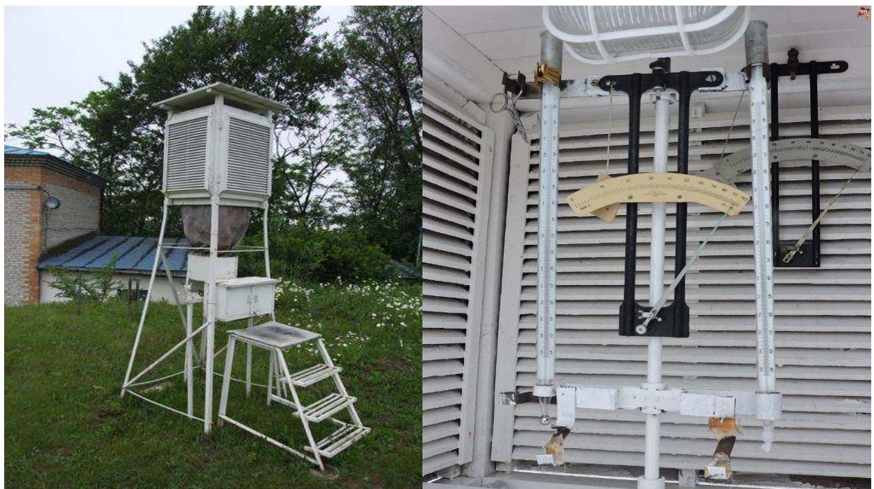
Рисунок 3 – Психрометрическая будка и ее внутреннее строение [12]
