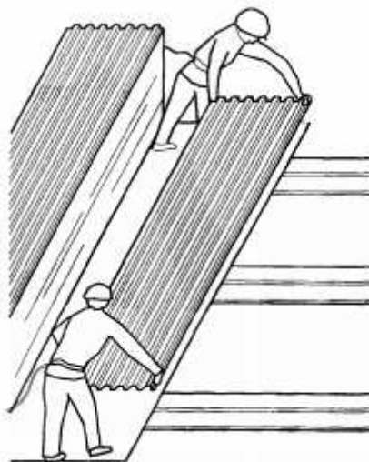
Рисунок 5.3.3 – Укладка стального профилированного настила.
