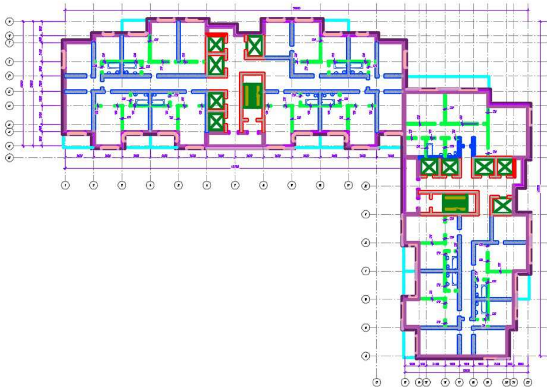
Рисунок 1.2 - Выполнение кирпичных перегородок
