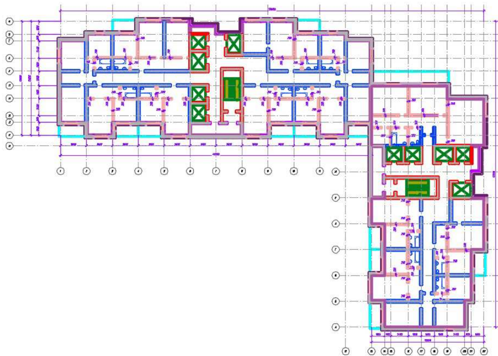
Рисунок 3 - Выполнение перегородок из пенобетона
