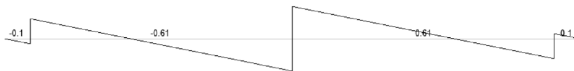
Рисунок 33 – Эпюра поперечной силы Q при складировании
