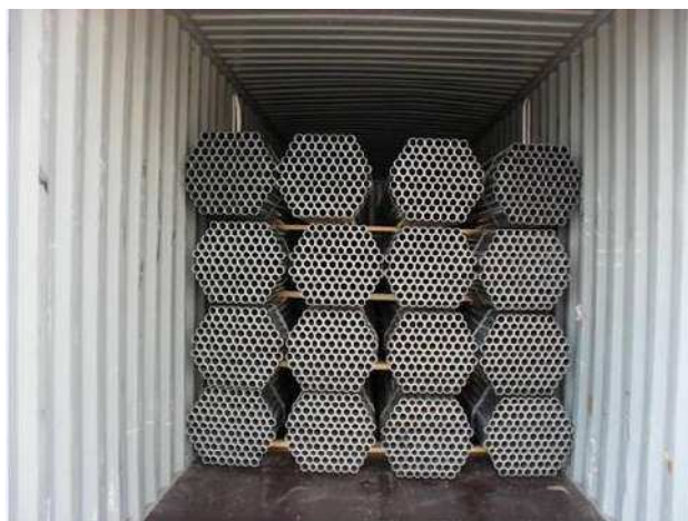
Рисунок 28 – Размещение труб пучками
