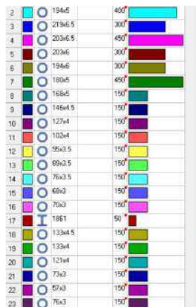
Рисунок 127 – Сечения сетчатого купола с учетом первой схемы монтажа
