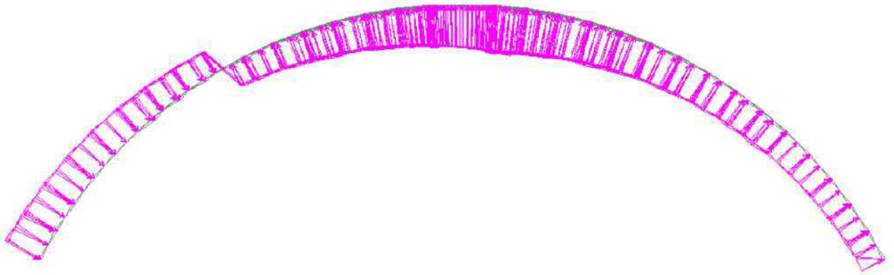
Рисунок 20 – Схема распределения ветровой нагрузки
