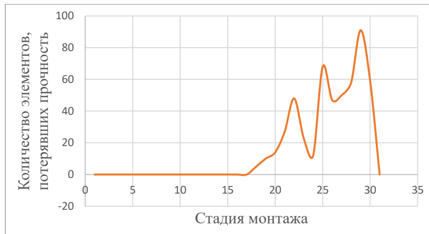
Рисунок 131 – Элементы, теряющие прочность (1 схема монтажа)
