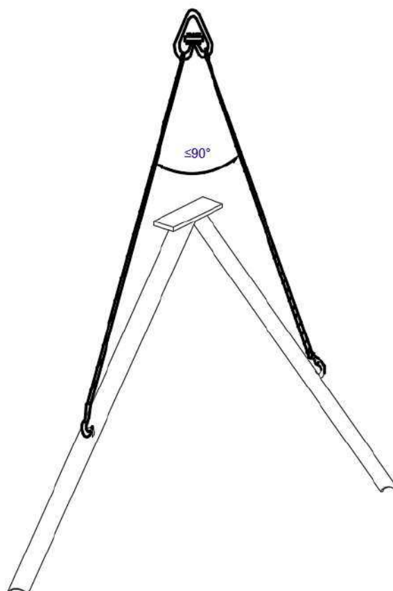
Рисунок 48 – Стрповка элементов первого ряда
