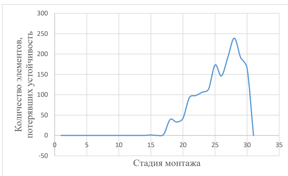
Рисунок 130 – Элементы, теряющие устойчивость (1 схема монтажа)
