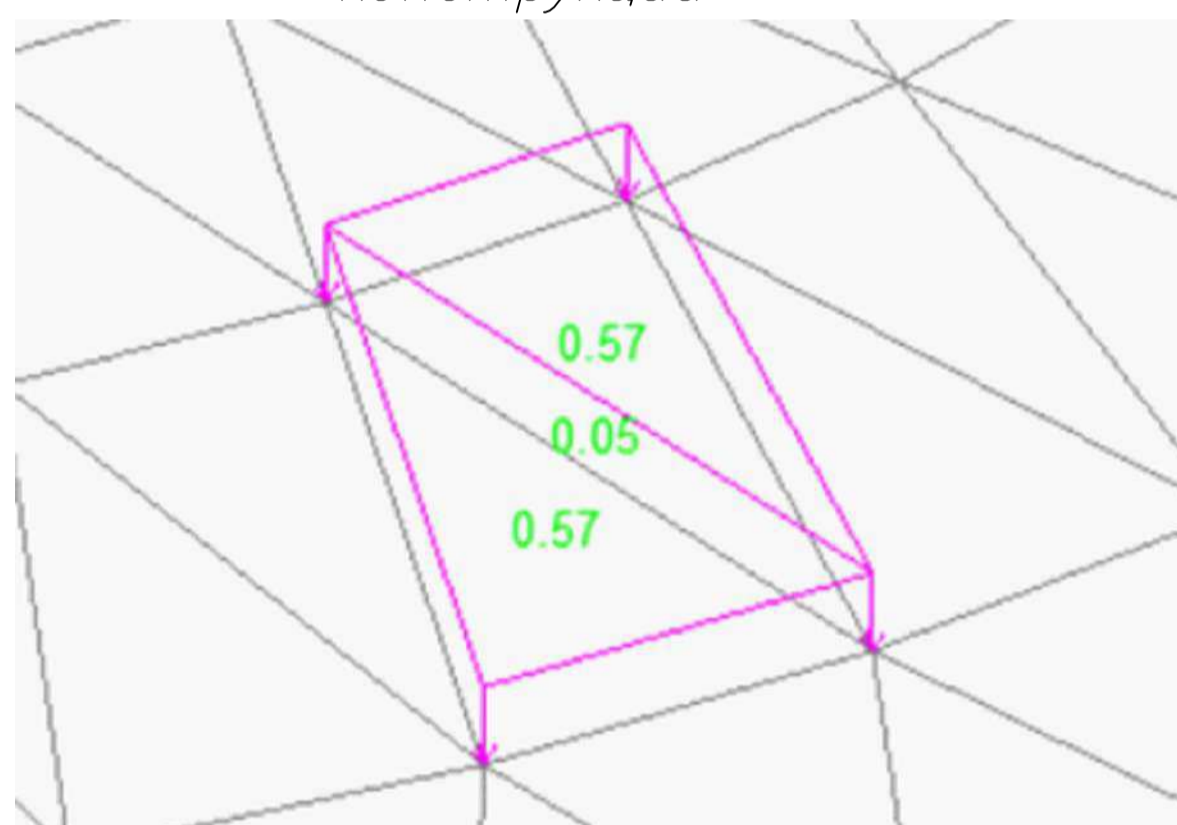
Нагрузка от «выключенного» элемента и опирающихся на него ограждающих конструкций
