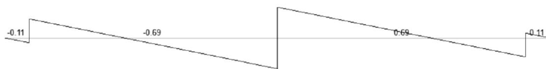
Рисунок 34 – Эпюра поперечной силы Q при транспортировке
