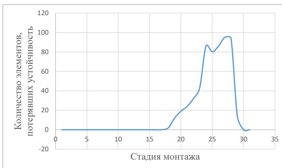
Рисунок 132– Элементы, теряющие устойчивость(2 схема монтажа)
