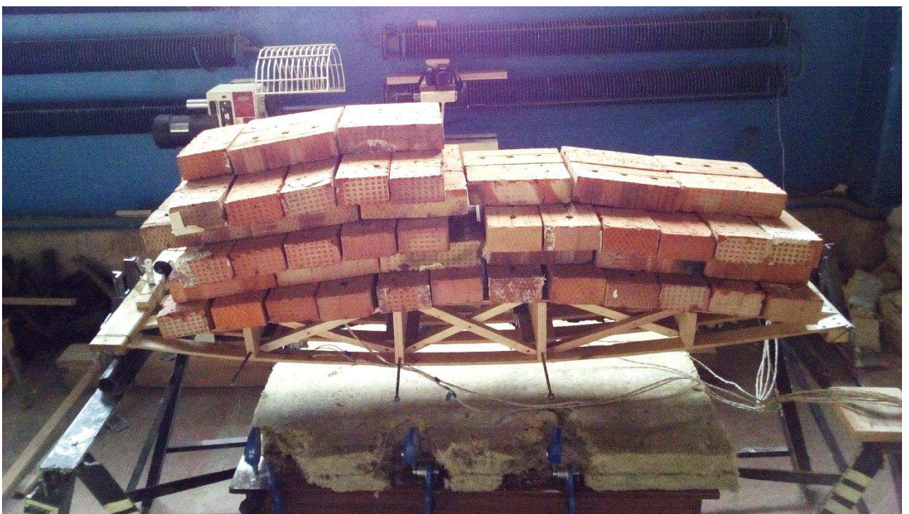
Рисунок 3.3.5 - Нагружение ЛПП расчетной распределенной односторонней нагрузкой ( 4,62 \text{ кН/м}^2 / 2,84 \text{ кН/м}^2 )
