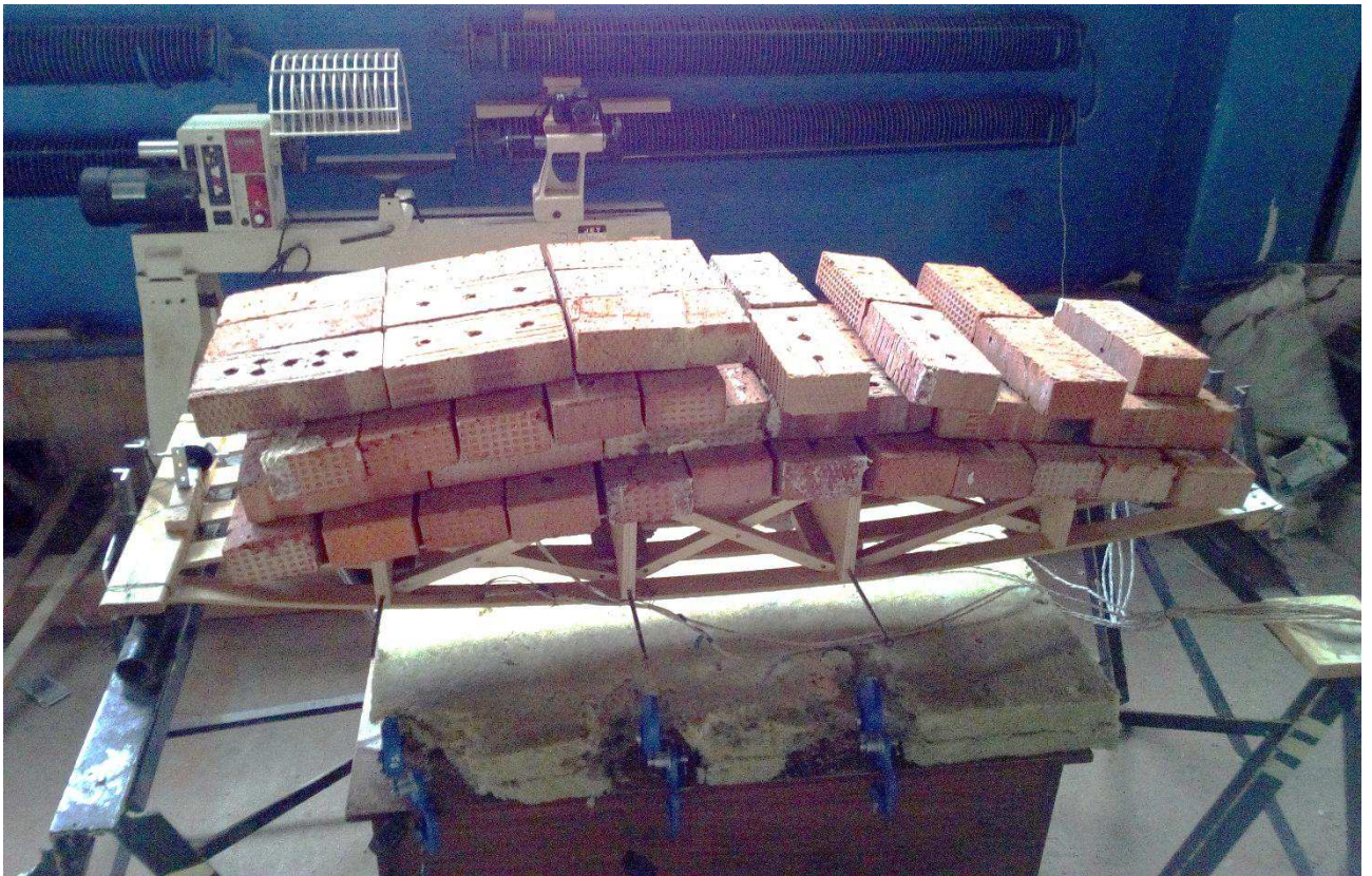
Рисунок 3.3.4 - Нагружение ЛПП нормативной распределенной односторонней нагрузкой ( 3,32 \text{ кН/м}^2 / 2,05 \text{ кН/м}^2 )
