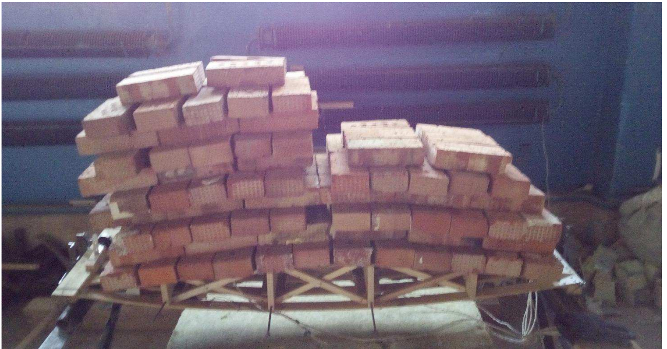
Рисунок 3.3.5 - Нагружение ЛПП распределенной односторонней нагрузкой, равной 1,5 q_{расч} ( 7,23 \text{ кН/м}^2 / 4,44 \text{ кН/м}^2 )
