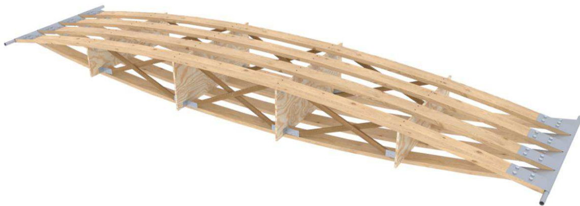
Рисунок 1.2.2.1 – 3D-модель пространственной плиты покрытия из деревянных полосовых элементов
