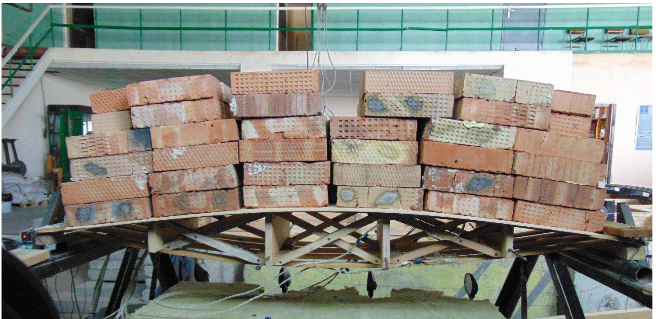
Рисунок 3.3.3 - Нагружение ЛПП расчетной равномерно распределенной равносторонней нагрузкой ( 3,73 \text{ кН/м}^2 )
