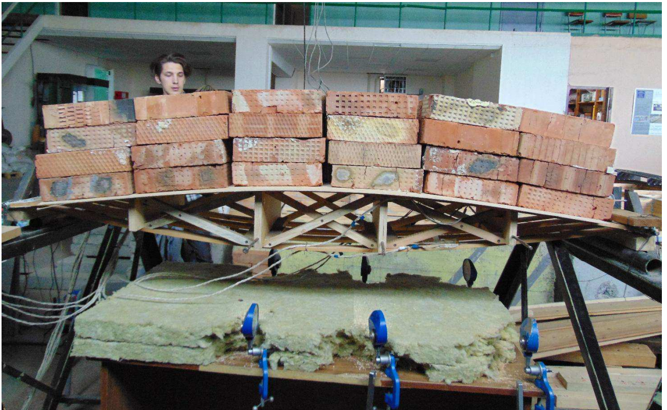
Рисунок 3.3.2 – Нагружение ЛПП нормативной равномерно распределенной равносторонней нагрузкой ( 2,69 \text{ кН/м}^2 )
