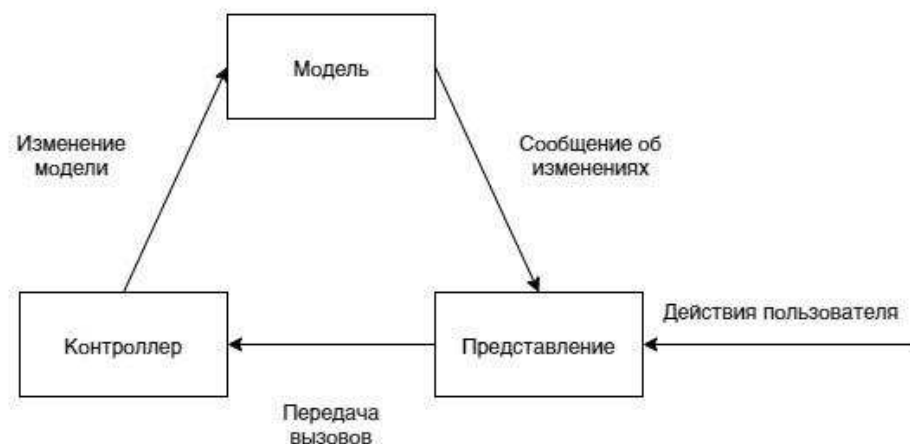
Рисунок 2 - Схема концепции MVC
