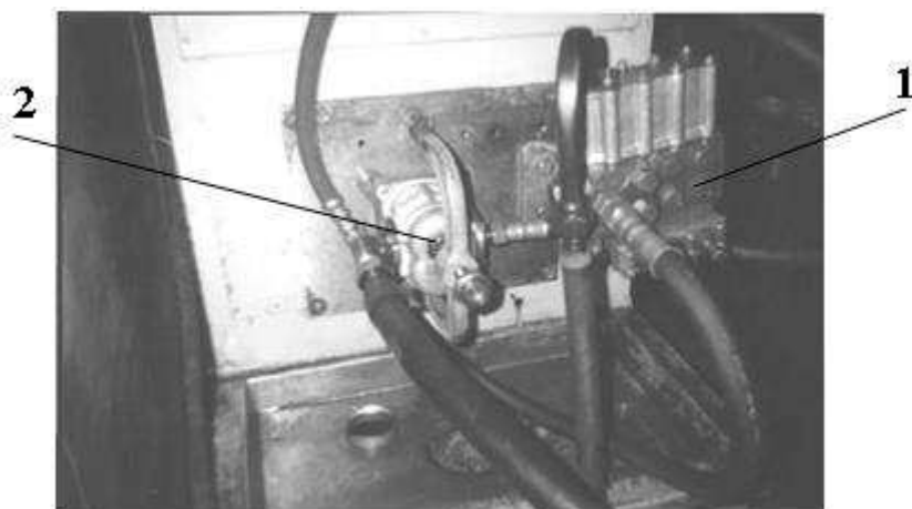
1 – гидрораспределитель Р75-В3А; 2 – гидронасос НШ-50У-3Л Рисунок 3.2 - Место установки гидроагрегатов на стенде
