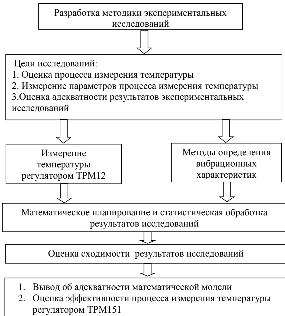
Рисунок 3.4 – Структурно-логическая схема экспериментальных исследований
