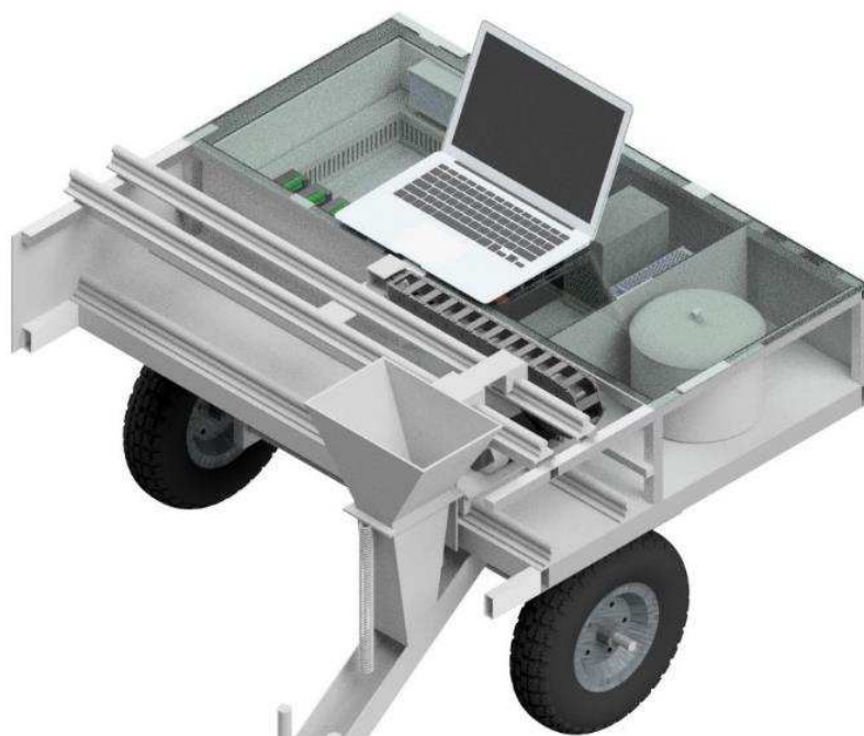
Рисунок 2.2 - Виртуальная модель дорожного принтера
