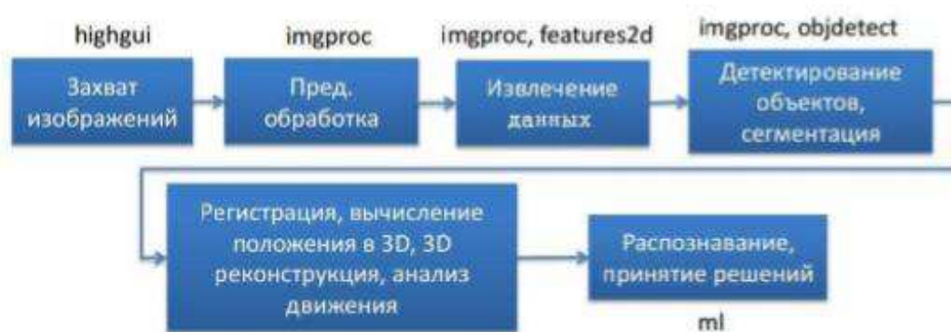
Рисунок 1.4 - Общая структурная схема приложения на OpenCV
