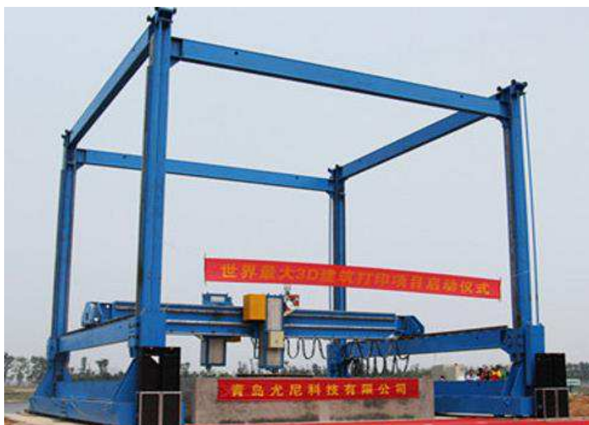
Рисунок 5 - 3D строительный принтер производства компании WinSun
