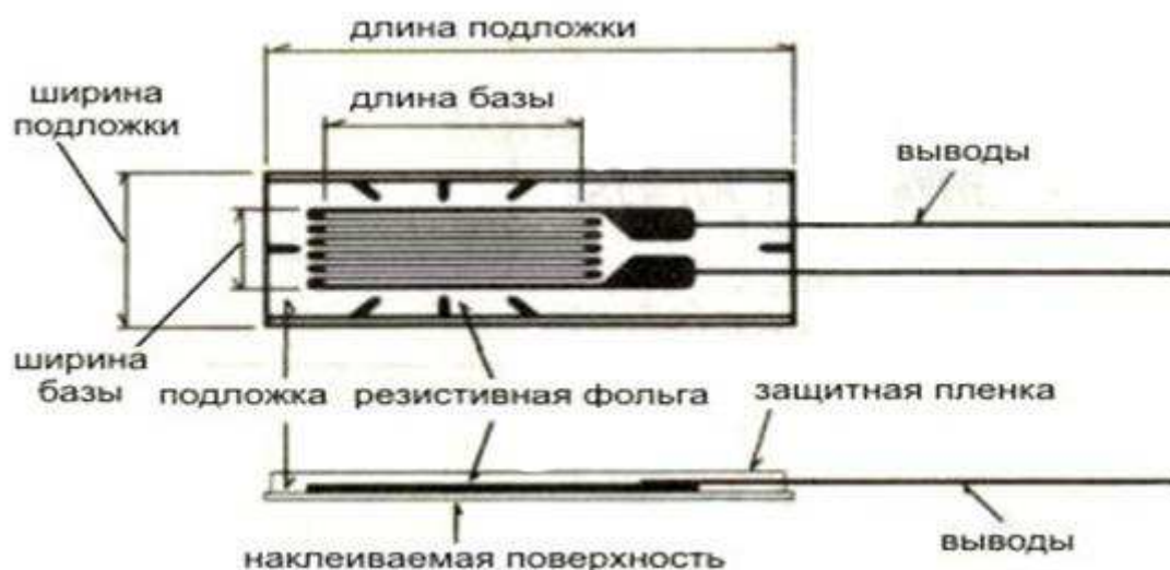
Рисунок 3.13 – Тензорезистор для определения деформаций бетона КС-70-120-А1-11
