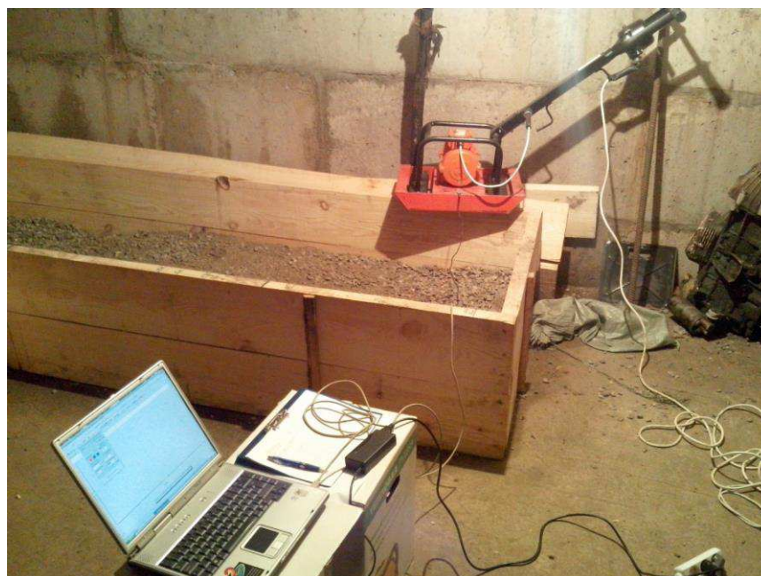
Рисунок 20 – Общий вид экспериментального оборудования и измерительного комплекса в лаборатории с грунтовым каналом
