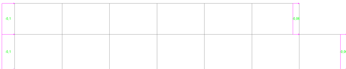
Рисунок 2.6 - Схема приложения ветровой нагрузки слева
