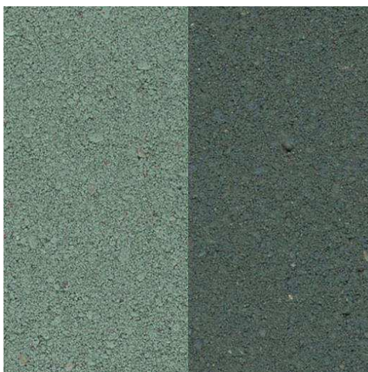
Рисунок 5 – Поверхность бетона на белом цементе (слева) и сером цементе (справа) с добавлением пигмента – цвет зеленый
