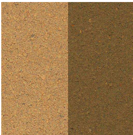
Рисунок 4 – Поверхность бетона на белом цементе (слева) и сером цементе (справа) с добавлением пигмента – цвет желтый
