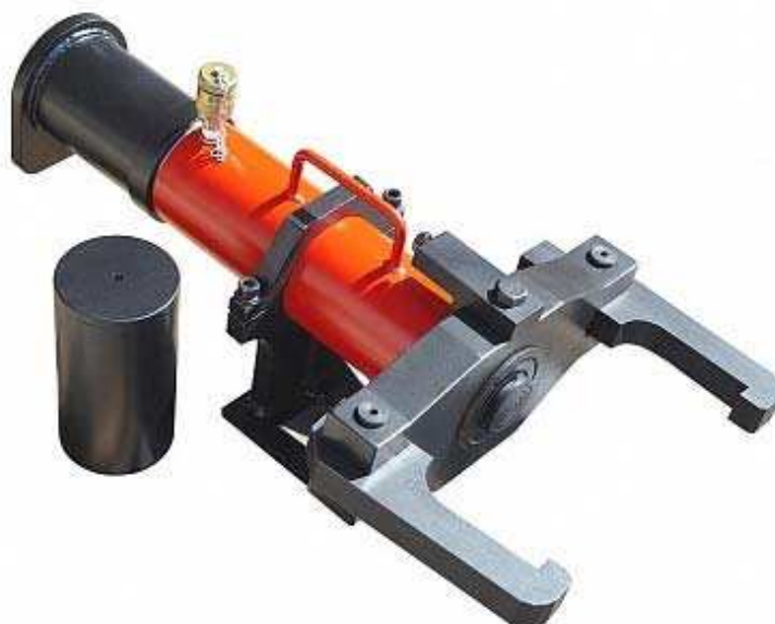
Рисунок 2.4 – Приспособление для демонтажа пальца переднего и заднего центрального шарнира подвески модели MSW-51CS
