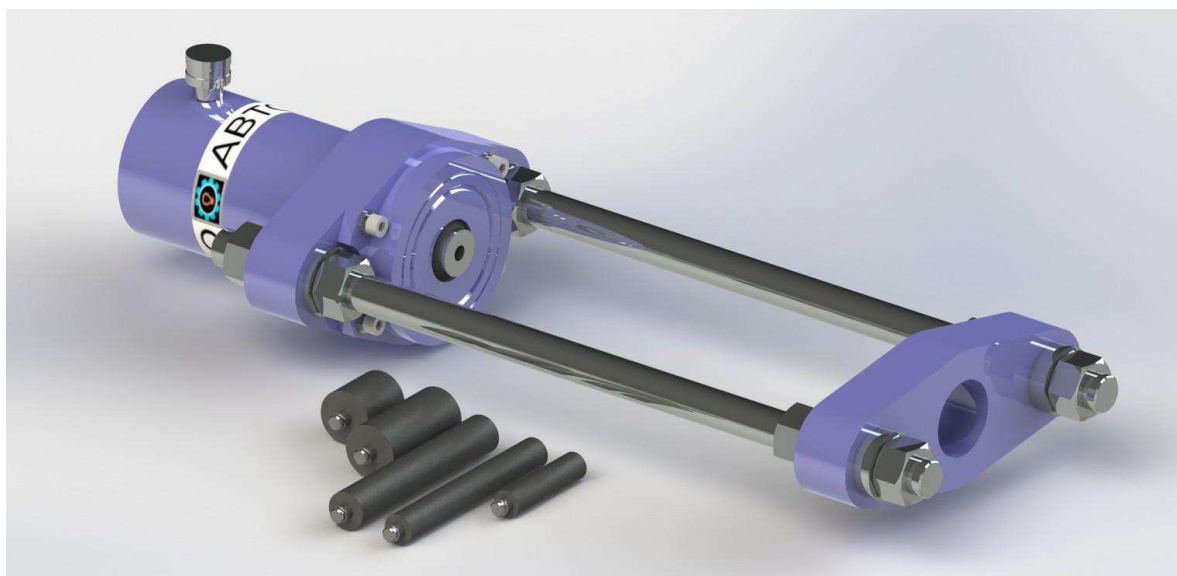
Рисунок 3.2 –Пресс для выпрессовки шкворней грузовых автомобилей (съёмник шкворней)
