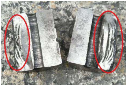
Механические повреждения двух роликов наружного конического подшипника, правого РМК, раздавлены
