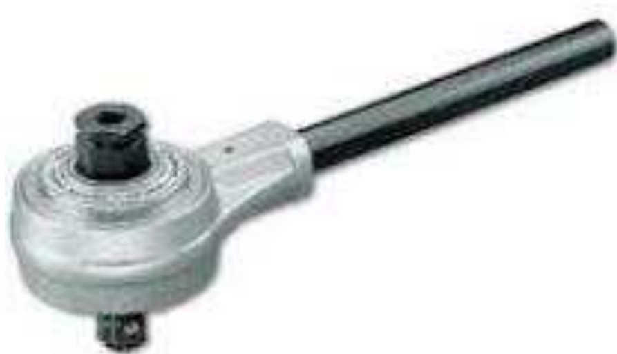
Рисунок 2.12 - редуктор усилитель крутящего момента Мультипликатор
