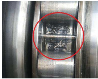
Отслаивание на внутреннем кольце ступичного подшипника
