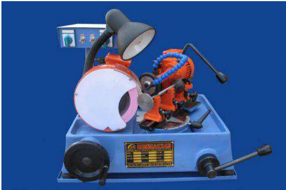
Рисунок 3.8 - Станок для шлифовки клапанов HST 16
