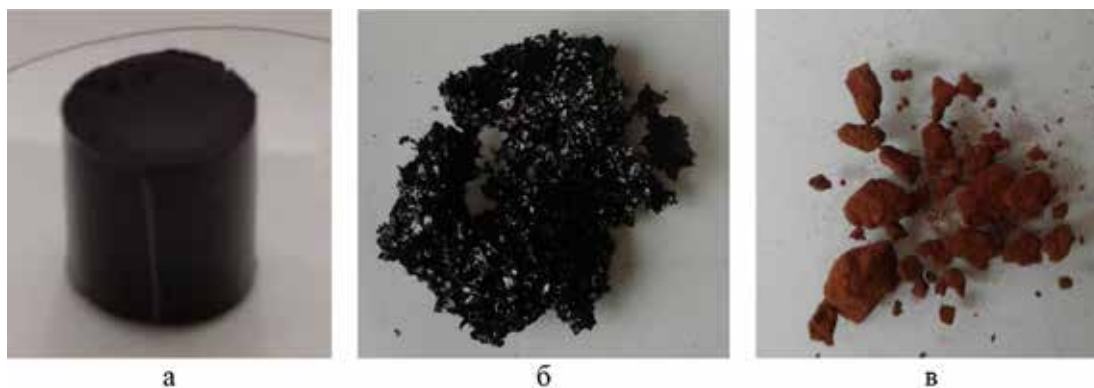
Рис. 1. Фотографии образцов органических ТФ-ксерогелей, полученных в присутствии HCl (а, б) и в среде NaOH (в)
