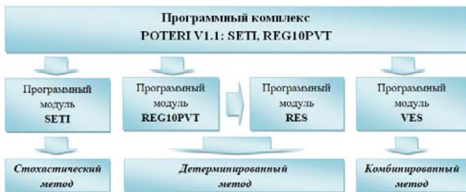
Рис. 3. Укрупненная модульная структура программного комплекса POTERI
