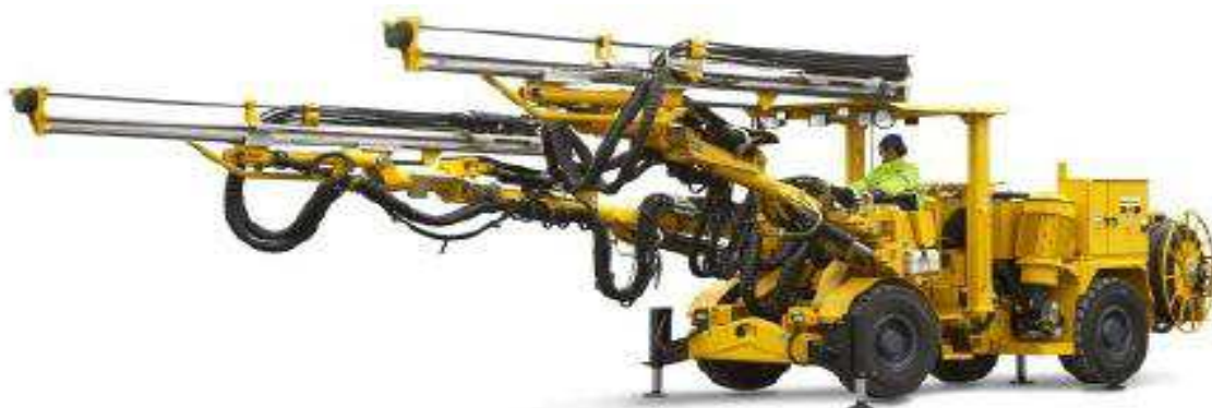
Рисунок 2.2 – Буровая установка Boomer 282
