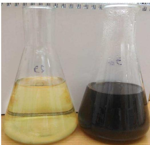
Рисунок 8 – Изменение цвета раствора при синтезе наночастиц
