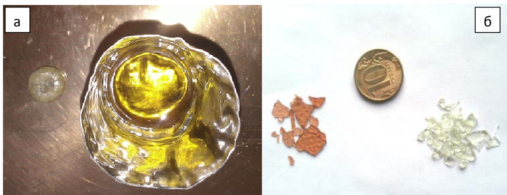
Рис. 1. Внешний вид образцов боратов висмута, полученных различными способами: а – охлаждение в тигле на воздухе и на металлической пластине, б – охлаждение в тигле (2 К/мин) (справа) и закалка между металлическими пластинами (слева)
