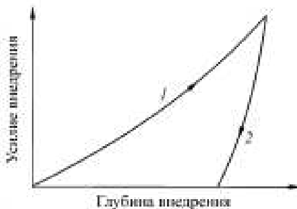
Рисунок 1- Диаграмма внедрения индентора: 1 — стадия нагрузки; 2 — стадия разгрузки
