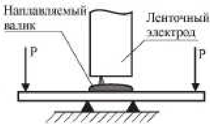
Рисунок 10 – Схема нагружения испытательной машины.
