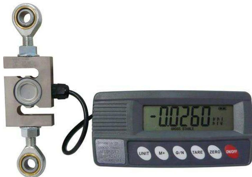
Рисунок 4 – Вид электронно-цифрового динамометра
