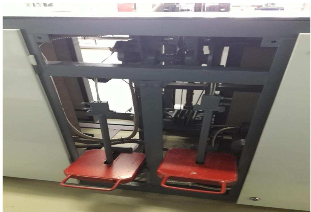
Рисунок 3 – Подвески грузов для создания воздействующей силы
