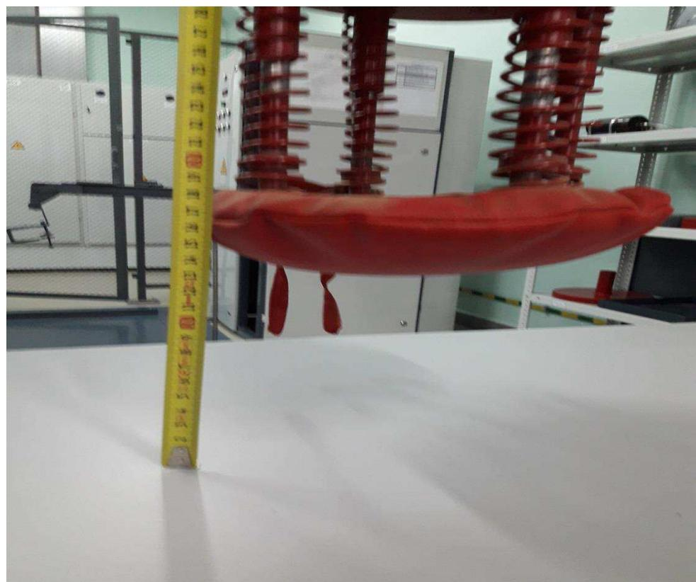
Рисунок 14 – Стенд для испытания изделий мебели на ударную прочность
