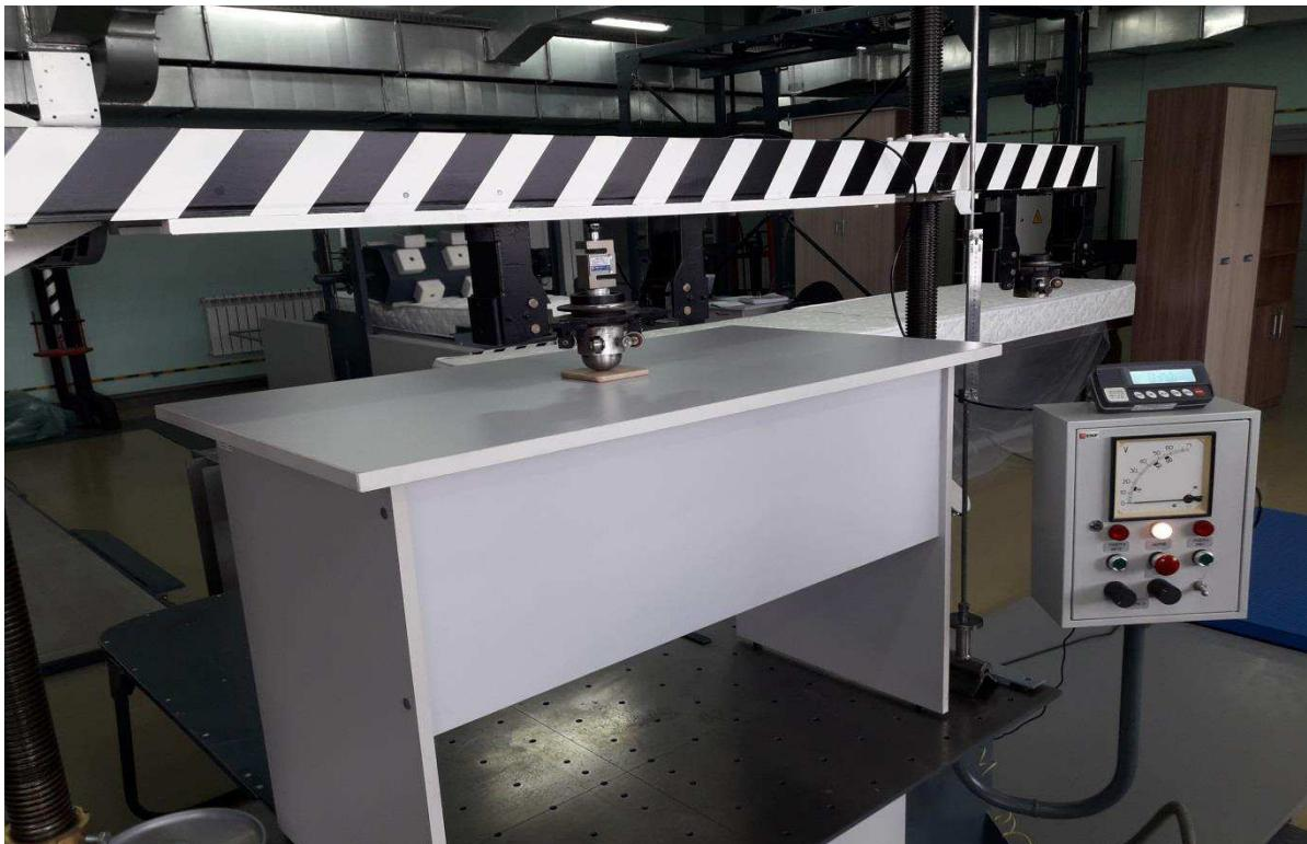
Рисунок 7 – Стенд универсальный И-645МБ для испытания изделий мебели
