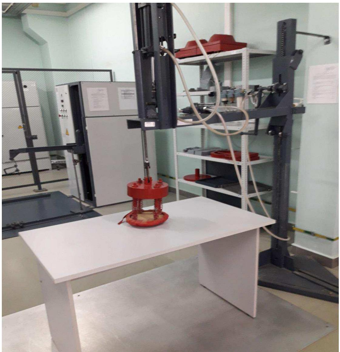
Рисунок 12 – Общий вид стенда И-УТ для испытания изделий мебели на ударную прочность
