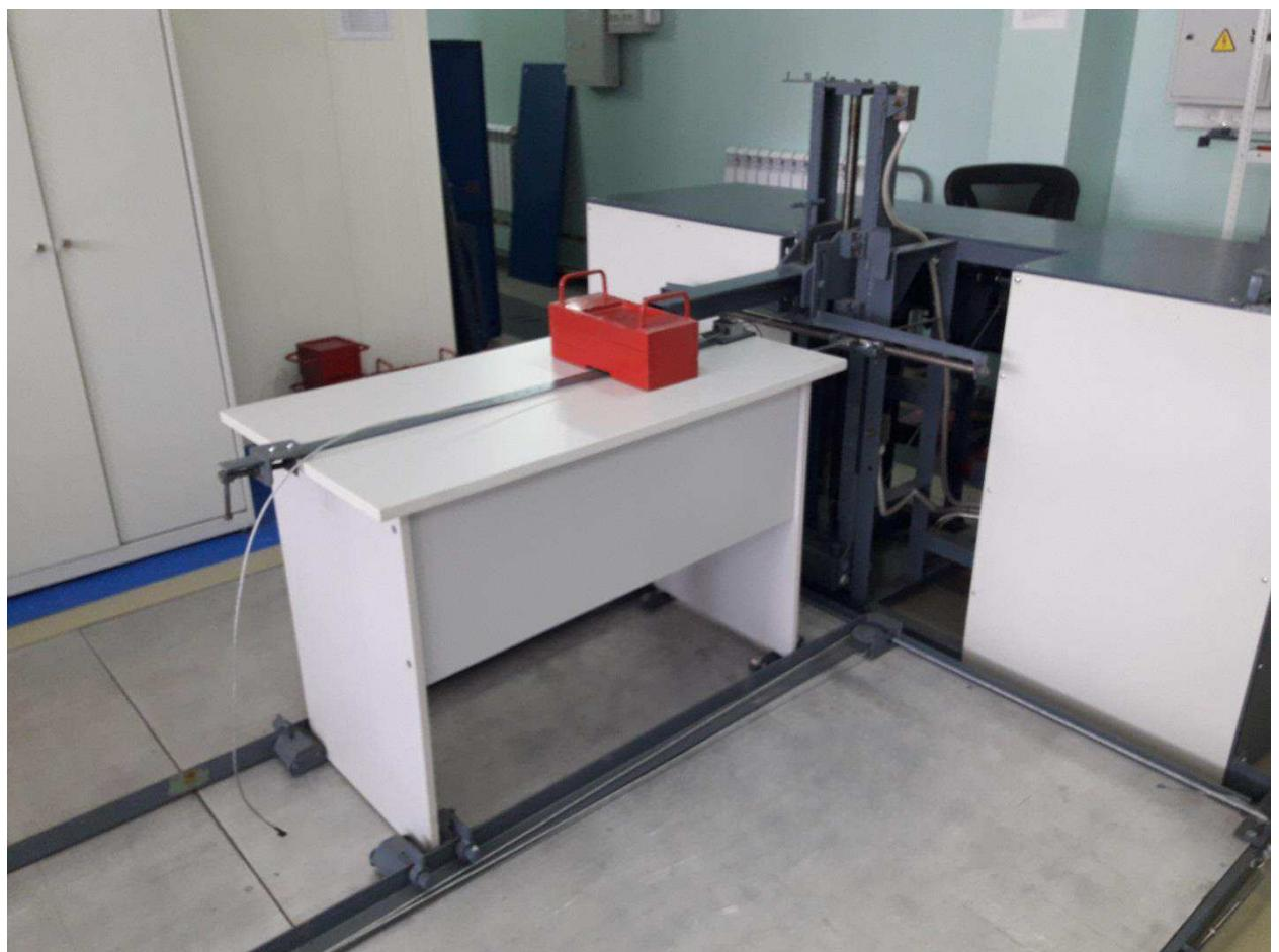
Рисунок 1 – Стенд И-195 для испытаний изделий мебели на долговечность и устойчивость
