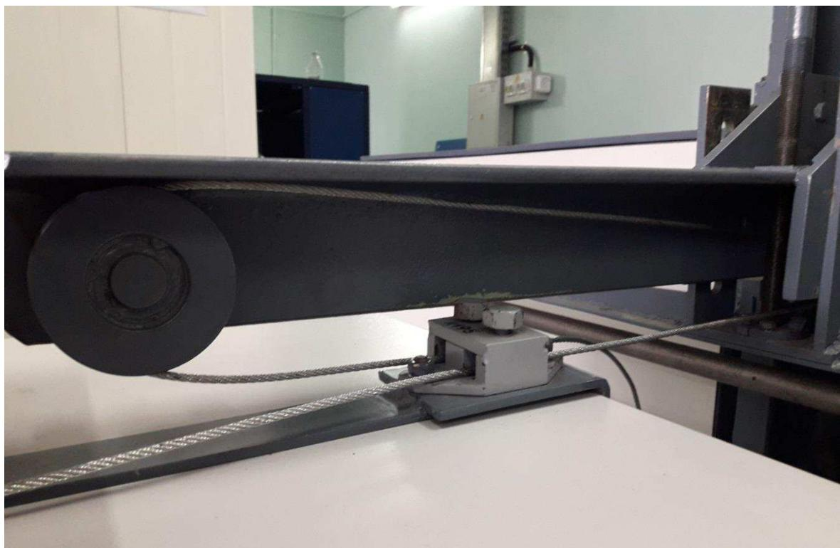
Рисунок 4 – Тросовая передача привода для создания горизонтальной циклической нагрузки на крышку стола
