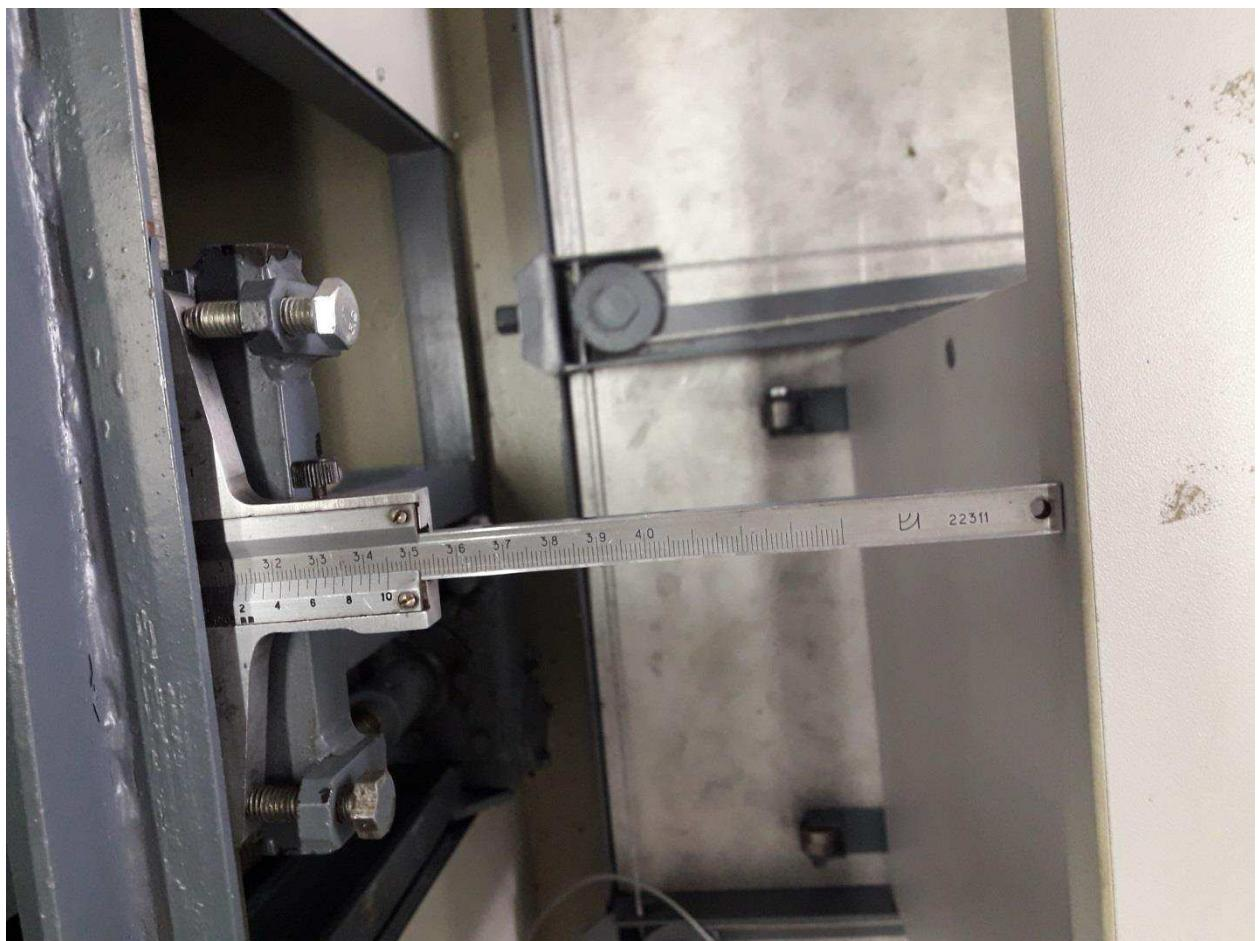
Рисунок 2 –Устройство для измерения деформации стола от действия горизонтальной циклической нагрузки
