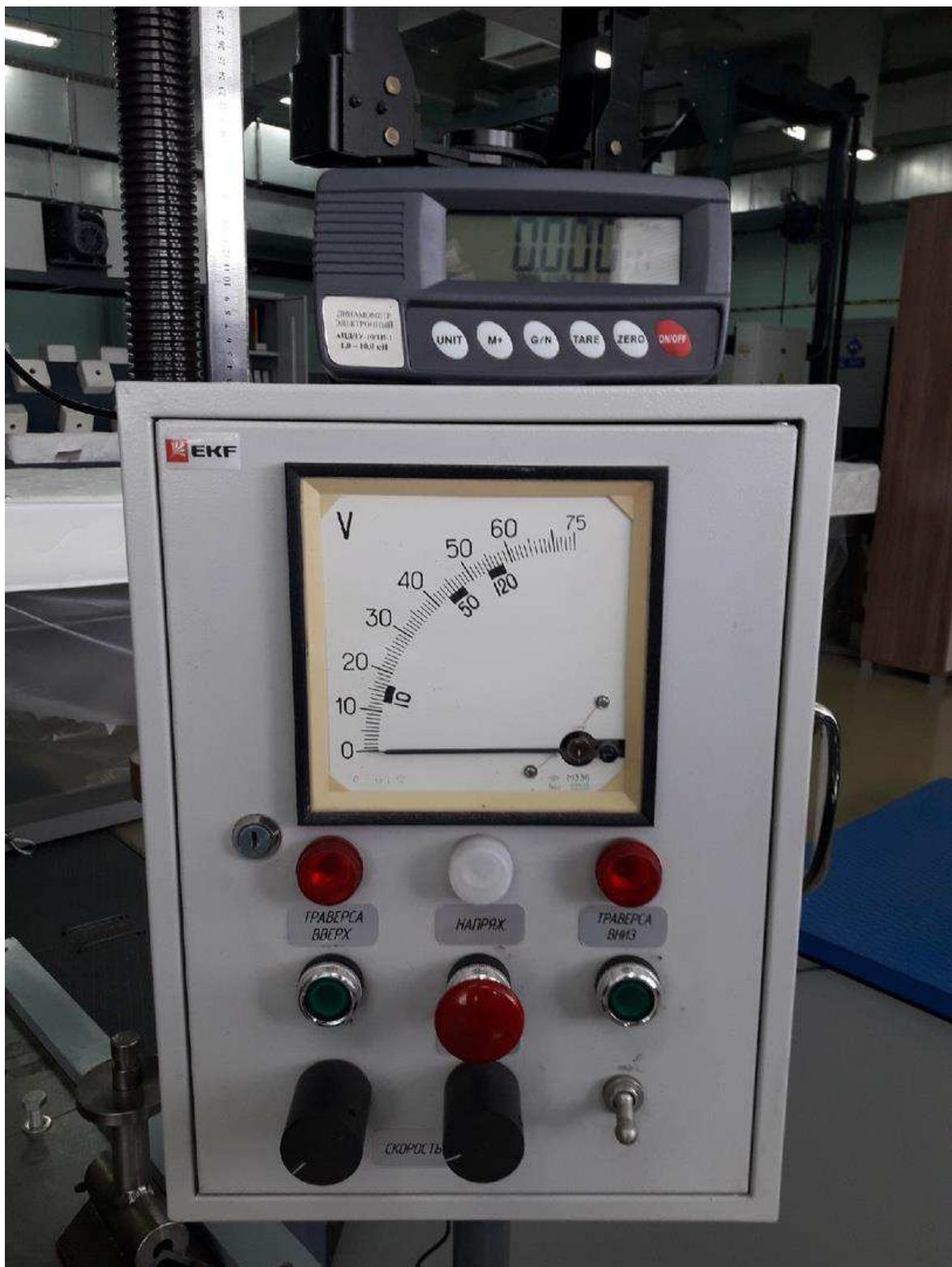
Рисунок 9 – Пульт управления с динамометром АЦД/1У-10/1И-1 стенд И-645МБ для испытания изделий мебели
