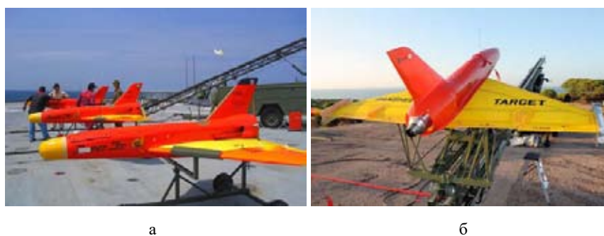
Рис. 5. БЛА «Banshee»: a – на рампе; б – на пневматической катапульте
