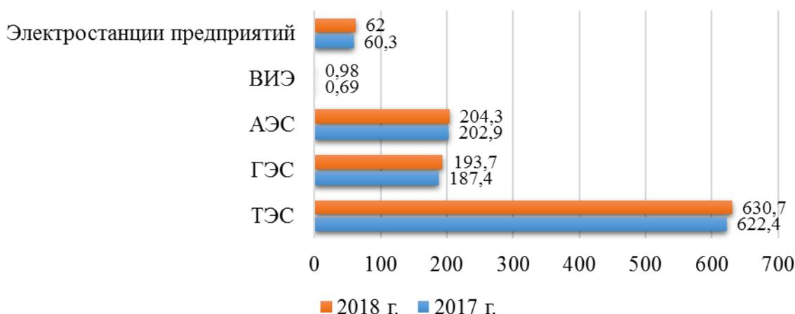
Рисунок 1 – Баланс электрической энергии за 2017–2018 гг., млрд. кВт.ч
