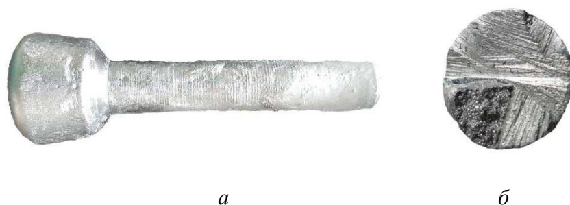
Рисунок 16 – Образец пеноалюминия: a – отливка; б – сечение образца со сколом
