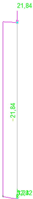
Рисунок Б.5 – Эпюра продольных сил, возникающих при действии на колонну постоянной нагрузки
