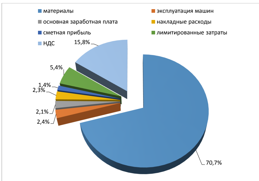
Рисунок 6.1 - Структура локального сметного расчета
