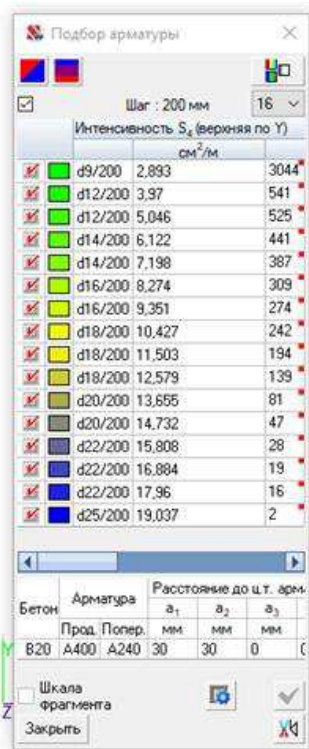
Рисунок 2.17 – Результат подбора арматуры верхней сетки по направлению оси Y
