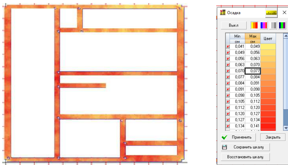
Рисунок 35 – Осадка свайно - ростверкового фундаментного основания.
