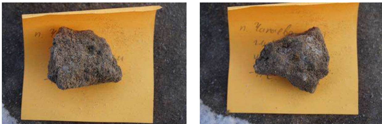
Рисунок 28 – Образец грунта для определения содержания влаги.
